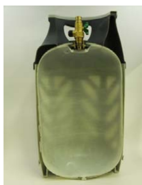
図3 液化石油ガス用一般複合容器（7.5kg 型容器）の断面（写真提供：中国工業株式会社）
